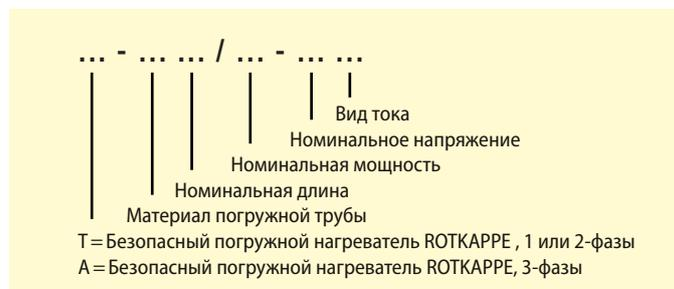
Пример: T-PS630 / 1,6 - 230Ws: ROTKAPPE погружной нагреватель с Anti-Burn-System; трубой из фарфора; номинальная длина трубы 630 мм; номинальная мощность 1,6 кВт; номинальное напряжение 230 В (однофазный).
